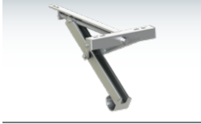
BÜNTE Ausdrehstütze, universal, 280 × 535 × 90 mm, Lochabstand max. 215/490 mm, mit 19 mm Sechskant, Ausdrehlänge 450 mm, Stützlast 500 kg, Stahl feuerverzinkt
