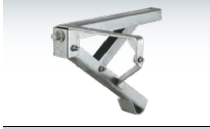
WINTERHOFF Ausdrehstütze, links, 290 × 465 mm, Lochabstand 123/420 mm, mit 19 mm Sechskant, Ausdrehlänge 480 mm, Stützlast 500 kg, Stahl verzinkt
