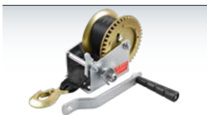
Seilwinde, Zuglast 900 kg, mit 50 mm × 8 m Gurtband, doppelter Antrieb, Getriebeuntersetzung 4,1:1
