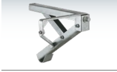
WINTERHOFF Ausdrehstütze, rechts, 290 × 465 mm, Lochabstand 123/420 mm, mit 19 mm Sechskant, Ausdrehlänge 480 mm, Stützlast 500 kg, Stahl verzinkt
