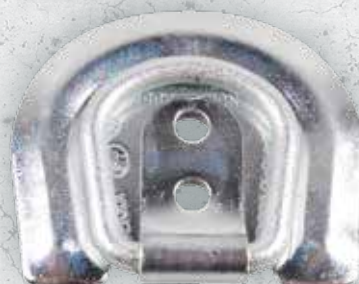
SPP ZURRMULDE mit Ring, UP-03B, Aufbau, L: 62 × B: 71 mm, 250 daN, verzinkt Art.-Nr. 402601
