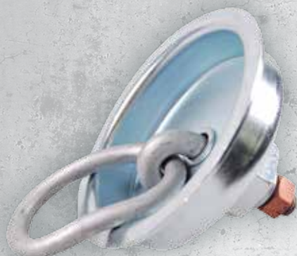
ZURRMULDE mit Ring und Schraube, drehbar, Ø 75 mm, Einbautiefe 16 mm, 500 daN, verzinkt Art.-Nr. 40272
